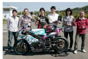
ボディデザイン：2012年に元GKデザインの黒川氏、製作 zeezoon の協力のもと空力に優れ、最新の風洞トレンドを取り入れつつ電動バイクならではの実利かつ機能的なデザインを作り上げた。そのデザインを3D化、ドライカーボンでカウルを成型。2013年度はデザインを継承しながらも、zeezoon 青島氏の手によりボディをさらにブラッシュアップするために、フロントカウル、リアシートを新たに製作。センターカウル以外は製作し直しさらに機能的になった。また、一般公道走行にも適応するためのライト穴兼カメラ穴、ウインカーやナンバーステーも製作。ナンバーを取得。レース仕様と一般公道仕様どちらも付け替えが出来るようになっている。
